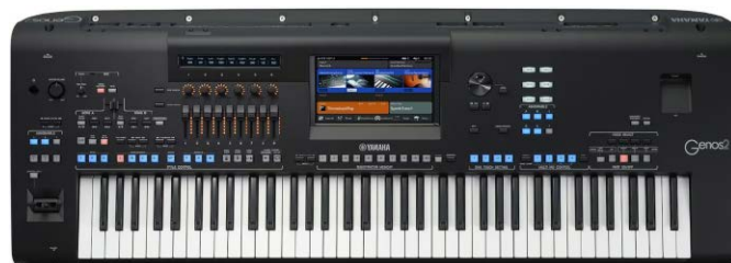
Fotografia 35. Stacja robocza Yamaha Genos2 realizuje funkcję kontrolera MIDI, klawiatury sterującej, sekwencera i całego oprogramowania DAW
