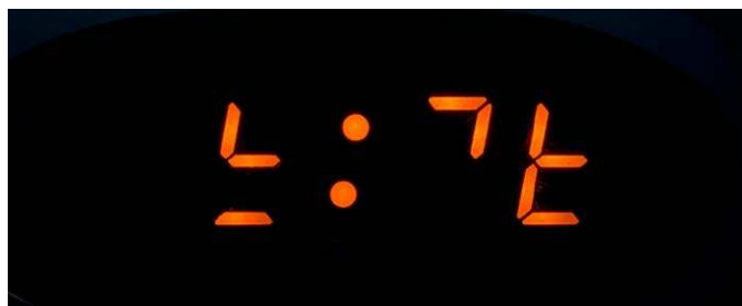
Fotografia 1. Zegarek z siedmiosegmentowym wyświetlaczem LED, sfotografowany za pomocą smartfona z czasem naświetlania aparatu ustawionym na 1/800 s. Doskonały przykład artefaktu wynikającego z relatywnie niskiej częstotliwości odświeżania multipleksu
