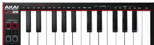
Fotografia 11. Klawiatura sterująca Akai LPK25 Mk 2 – przykład kontrolera MIDI pozbawionego dodatkowych elementów kontrolnych
