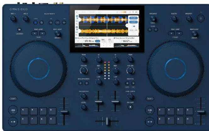
Fotografia 20. Kontroler AlphaTheta Omnis-Duo, który może pracować zarówno samodzielnie, jak i sterować oprogramowaniem DJ-skim na komputerze
