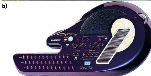
Fotografia 34. Yamaha-Suzuki Omnichord OM-27 (a) i późniejszy model Qchord QC-1 (b) – kontrolery, w których akordy wybiera się za pomocą prostej klawiatury, a gra przesuwając palcem po płytce dotykowej
