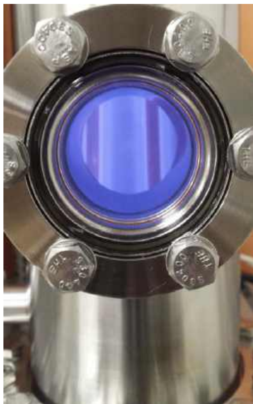
3. Bogata w \text{CO}_2 laboratoryjna atmosfera poddawana wyładowaniom plazmy
