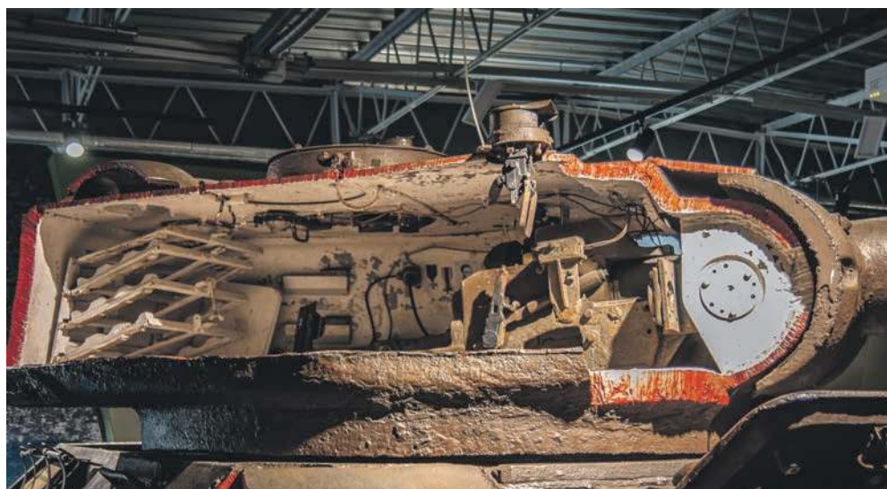
Czołg T-34 z serialu „Cztery pancerni i pies” – na zdjęciu widać otwory w pancierze wykonane dla ułatwienia kręcenia zdjęć filmowych
