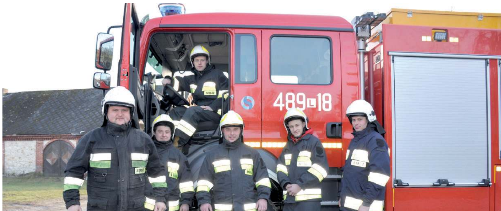
Średni samochód ratowniczo-gaśniczy z napędem na cztery koła, na podwoziu Mana, wyprodukowany został w Kielcach. W zbiorniku mieści się trzy i pół tysiąca litrów wody, a wydajność autopompy to 2 900 l na minutę
