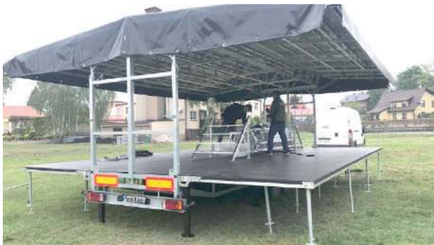
Całą konstrukcję będzie można łatwo przetransportować na przyczepie i ustawiać w różnych miejscach
