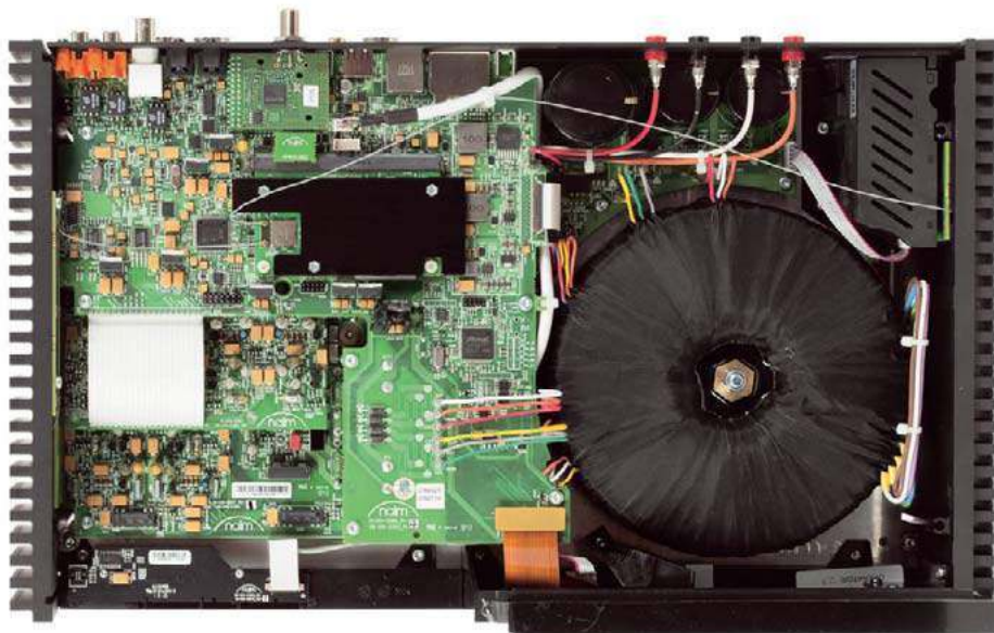
Układy liniowe wymagają dużych elementów i chłodzenia, wewnątrz jest napakowane elektronika, systemy cyfrowe znajdują się na górze.
