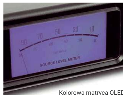
Kolorowa matryca OLED pełni różne zadania, prezentuje informacje o nagraniach, ale też efektownie „udaje” analogowy wskaźnik.
