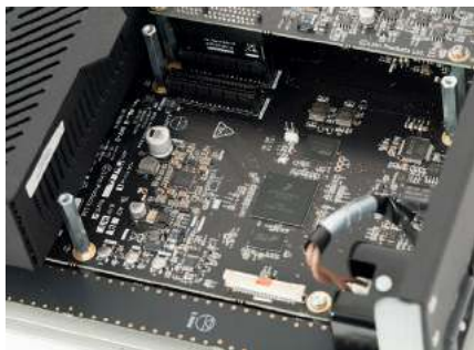
Główna płytką to tzw. Kore Board, gdzie wstęp mają wyłącznie sygnały cyfrowe.
