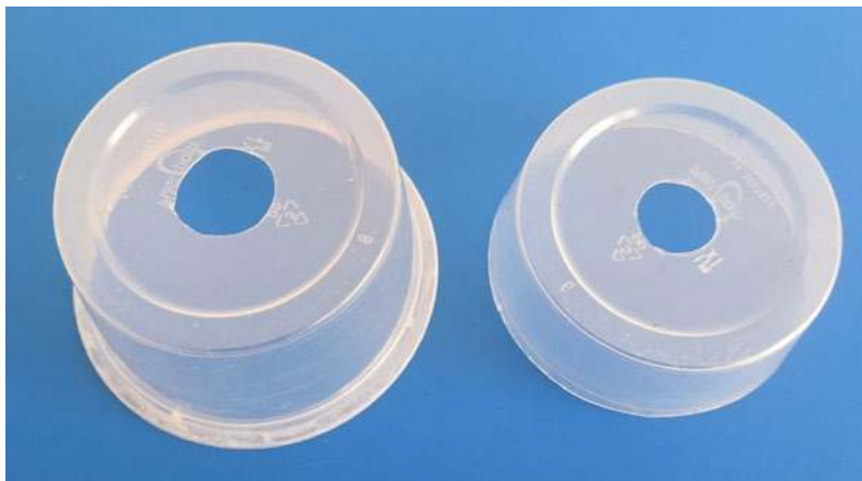
Fot. 11. Przyrząd do naprężania tkaniny, ułatwiający obserwacje efektów optycznych: a) części składowe, b) widok po złożeniu.
