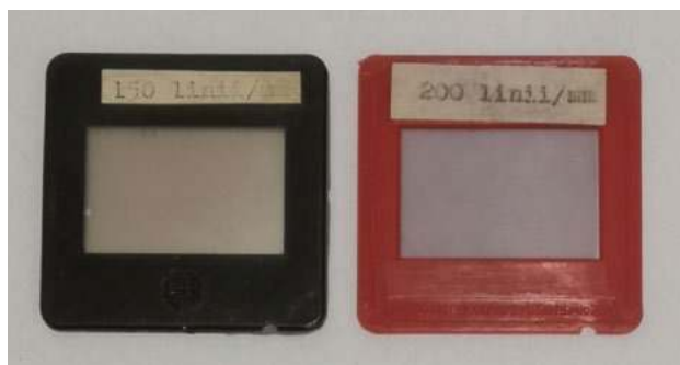
Fot. 1 Przykłady spotkanych w szkołach siatek dyfrakcyjnych starszego typu.
