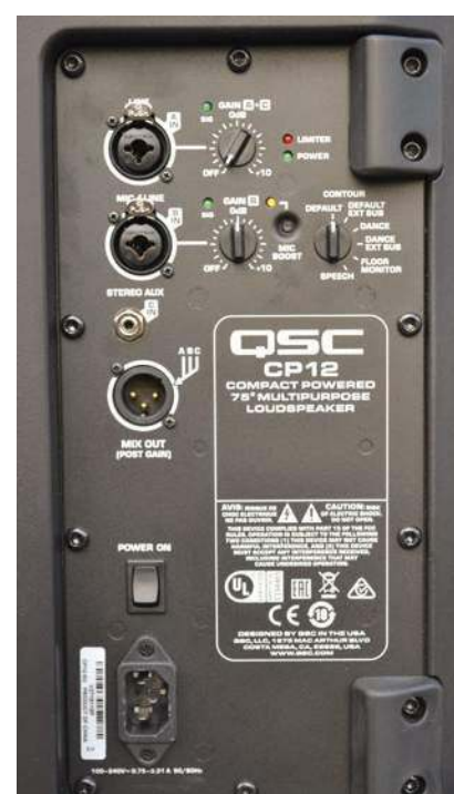
...zwierający wszystkie gniazda sygnałowe, gniazdo i wyłącznik zasilania oraz manipulatory.
