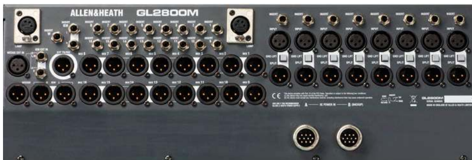
Tylny panel konsolety – widać wbudowany splitter mikrofonowy.
