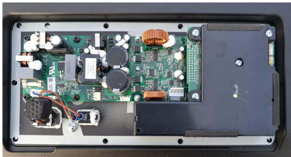
Cała elektronika mieści się na jednej płycie – DSP, układy wejściowe i końcówki mocy zamknięte są w szczelnej puszcze plastikowej.
