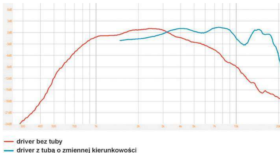
Rysunek 3. Charakterystyka częstotliwościowa drivera ciśnieniowego.
