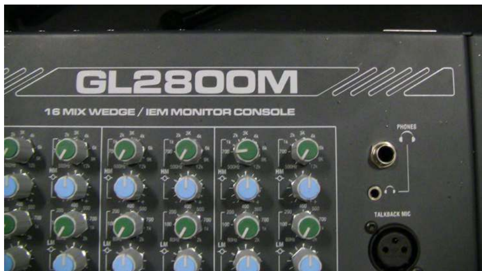
Dodatkowe gniazdo mini jack 3,5 mm pozwalało na podłączenie typowego zestawu słuchawkowego.
