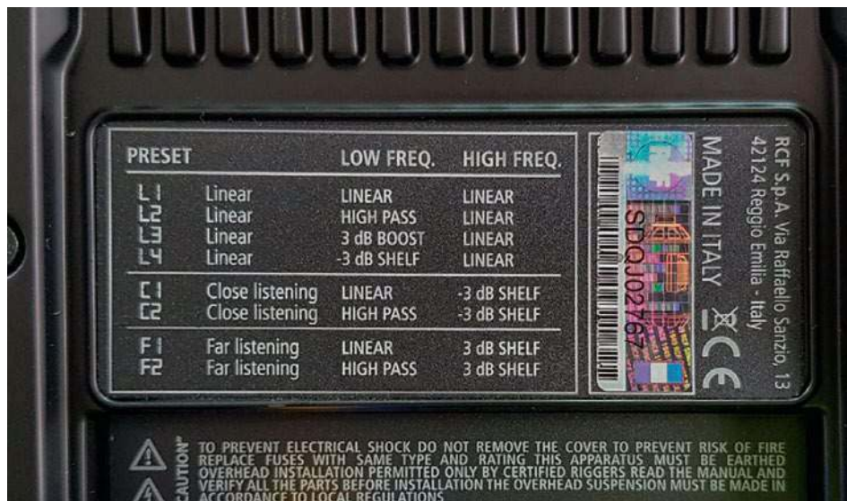
Znajdująca się nad gniazdami Powercon „ściąga” dość jasno i klarownie informuje, w jaki sposób poszczególne preset-y korygują brzmienie zestawu.
