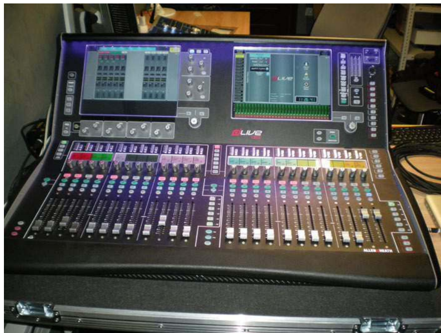
Do realizacji dźwięku służy konsola Allen & Heath z serii dLive, składająca się z powierzchni sterującej C3500...
