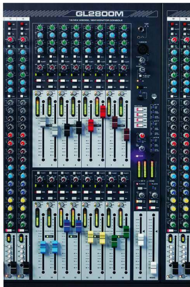
Sekcja MASTER. Po prawej stronie widoczne przełączniki ustawień globalnych.
