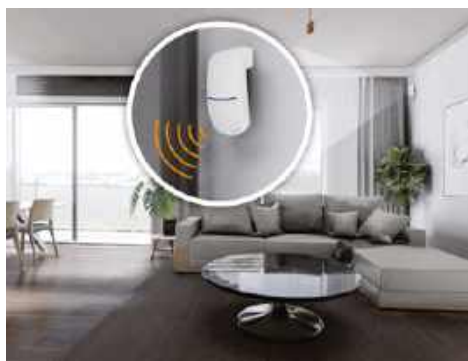
Do wyboru są czujniki wykorzystujące podczerwień albo mikrofałę, a także dualne, korzystające z obu tych systemów detekcji. SATEL
