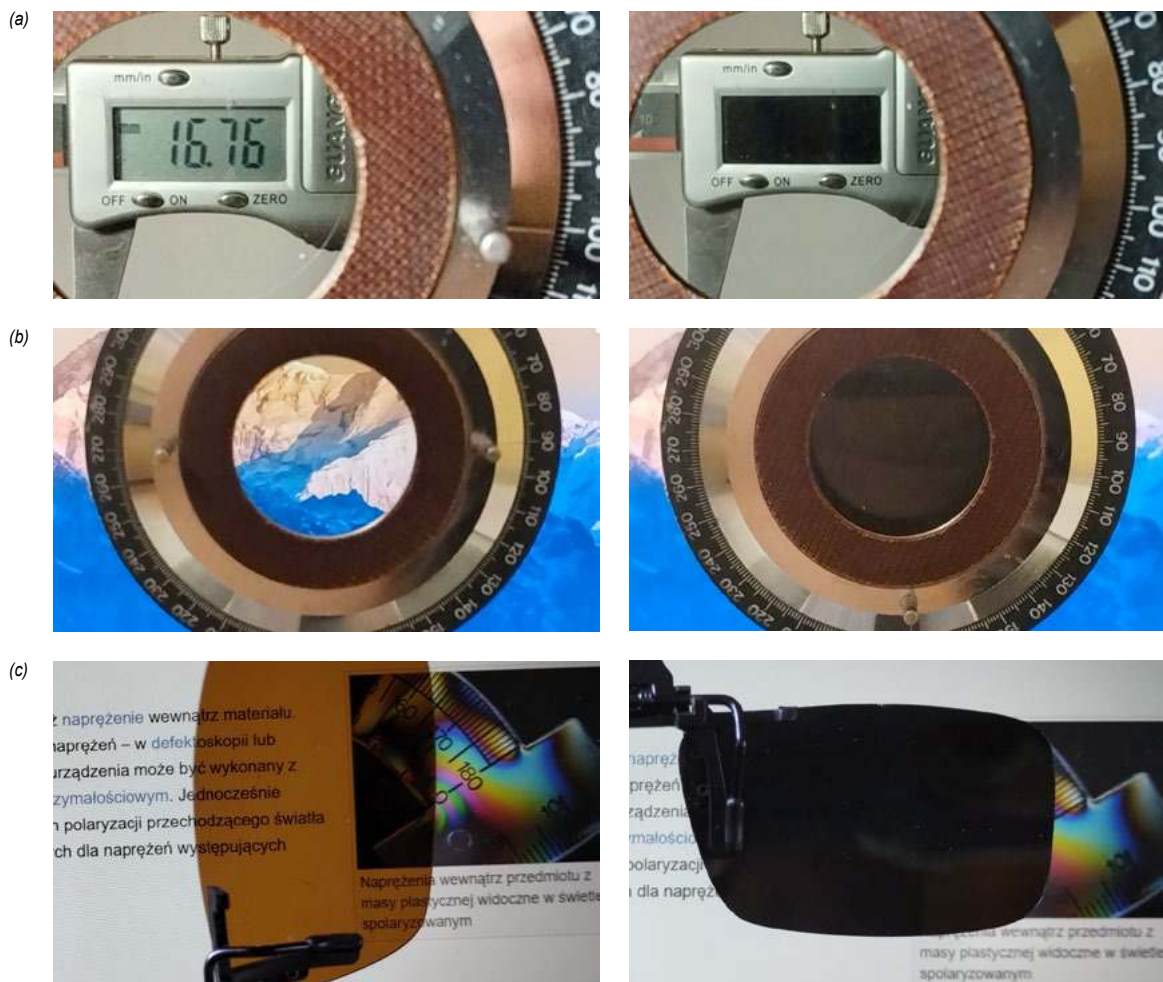
Rysunek 13. Wyświetlacz (a) suwmiarki elektronicznej i (b) ekranu ciekłokrystalicznego oglądany przez polaryzator o osi równoległej do płaszczyzny polaryzacji światła wychodzącego z wyświetlacza (zdjęcia po lewej) i prostopadłej (zdjęcia po prawej stronie). (c) Ekran ciekłokrystaliczny oglądany przez okulary przeciwsłoneczne z filtrem polaryzacyjnym. Na zdjęciu po lewej stronie oś polaryzatora jest równoległa do płaszczyzny polaryzacji światła wychodzącego z ekranu. Na zdjęciu po prawej stronie oś polaryzatora jest prostopadła do płaszczyzny polaryzacji światła.
