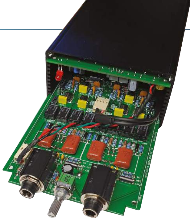
Montaż jest ciasny, ale przy zalecanych długościach kabli, tłumik wysuwa się na tyle, aby umożliwić podłączenie złączy sygnałowych i przewodów zasilających. Uważaj jednak, aby kable nie zaczepiały się o części na płycie głównej SuperKodeka. Zdjęcie przedstawia urządzenie od przodu w normalnej pozycji
