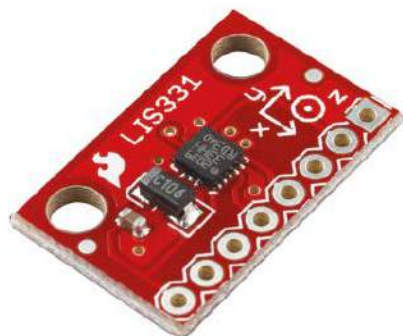
Rysunek 4. Płytki SMD breakout są nowym przystawieniem dla hobbyistów!
