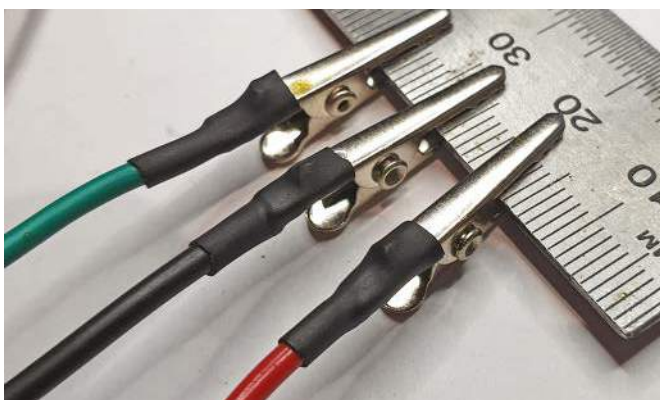
Zaizolowaliśmy krótkimi odcinkami rurki termokurczliwej miejsca lutowania przewodów do krokodylków. W tym momencie gumowe osłonki zacisków znajdowały się już na przewodach, z tyłu zacisków. Ich rozwarcie przez zaciśnięcie na listwie ułatwia nasunięcie osłonek na krokodylki
