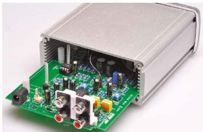
Gotową płytkę PCB po prostu wsuwa się w wytłaczaną obudowę, tak że oś potencjometru i przełącznik znajdują się na przednim panelu. Nie ma potrzeby przykręcania płytki PCB, ponieważ jest ona trzymana mocno w słoicie przez przednią i tylną część obudowy
