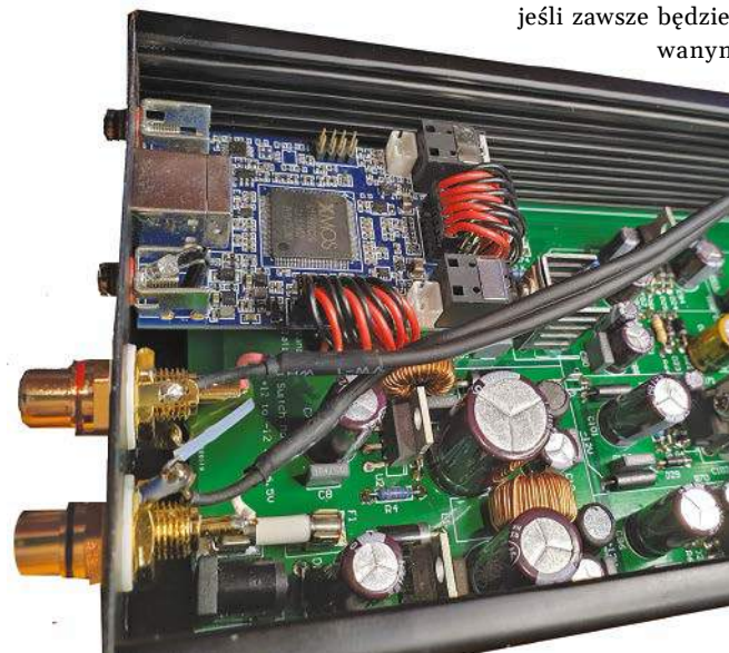
Widok podczas montażu ze zdjętym panelem dolnym. Następnie wsuwamy płytkę tłumika w najniższe sloty (na fotografii najwyższe), elementami w kierunku płytki głównej na samej górze (na fotografii widoczna dole)
