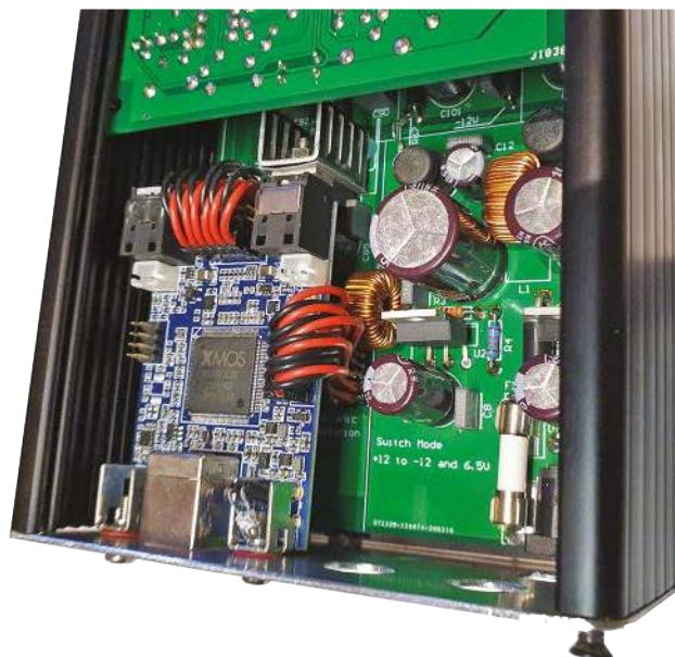
MCHStreamer jest mocowany do tylnego panelu za pomocą zestawu tulei izolacyjnych na śrubach M3, podkładek izolacyjnych oraz izolacyjnej ramki gniazda USB. Nie zapomnij o tym: Widok od spodu i od tyłu
