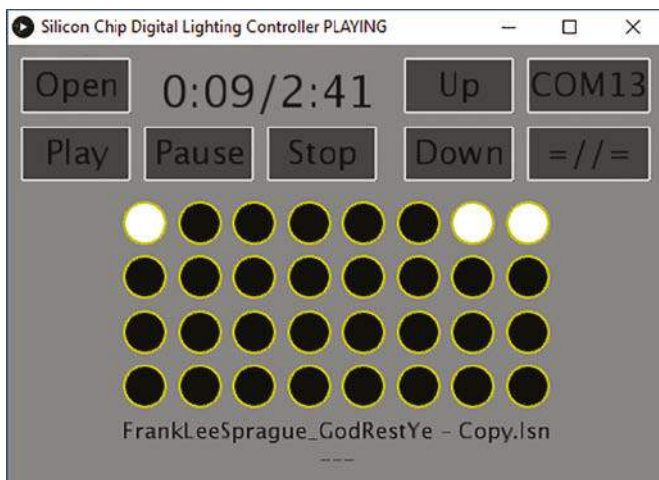
Ekran nr 5. Nasze oprogramowanie demonstracyjne odtwarza pliki sekwencyjne wygenerowane przez oryginalne oprogramowanie Digital Lighting Controller z 2010 roku. Ma kontrolki naśladowania lamp, dzięki czemu można łatwo sprawdzić, czy wszystko działa zgodnie z oczekiwaniami
