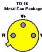
Wyprowadzenia i wewnętrzny schemat LT3092 firmy Linear (© Układy analogowe)
