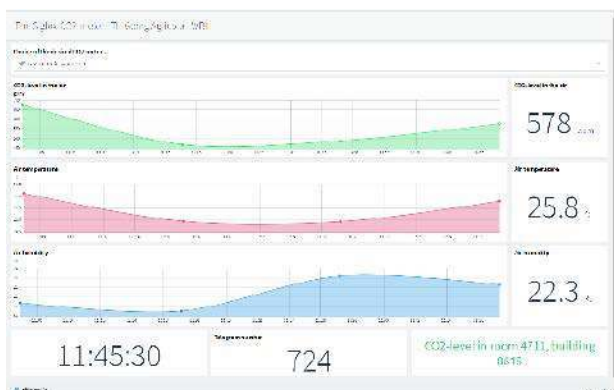
Rysunek 18. Pulpit nawigacyjny sygnalizacji świetlnej poziomu CO 2 . Od góry: stężenie CO 2 w powietrzu, temperatura powietrza i jego wilgotność
