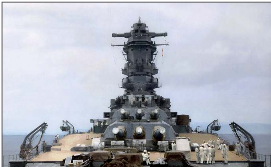
Imponująca sylwetka typu Yamato maskowała fatalną przeżywalność systemów dowodzenia. Wysoka, niemal nieopancerzona „wieża pagoda” była idealnym celem. Na topie widoczny zespół dalecełownika 98-Shiki z 15-metrowym dalmierzem stereoskopowym. Jak pokazał przykład Musashi , pojedyncza bomba ułożona w rejonie dalecełownika głównego zamieniała ten wart miliony jenów pancernik w mobilną „ślepą” baterię, niezdolną do nawiązania walki z jednostkami nawodnymi.
