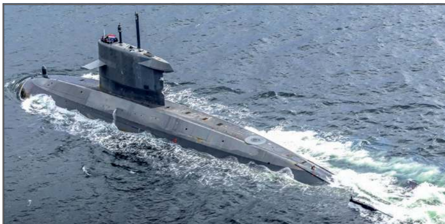
HNLMS Dolfijn (S808) na powierzchni. Widoczny ślad torowy generowany przez wolnoobrotową śrubę o siedmiu łopatkach typu „skew-back”.
