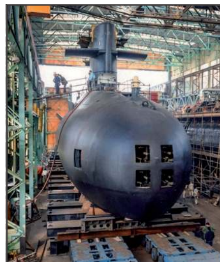
HNLMS Bruinvis (S810) podczas gruntownej modernizacji w ramach IP-W (Instandhoudingsprogramma Walrus-klasse) w hali montażowej/remontowej stoczni Damen Schelde Naval Shipbuilding. Zdjęcie unikatowo eksponuje kadłub ciśnieniowy jednostki po zdemonstrowaniu m.in. pokryw wyrzutni torped, a także osłony hydrodynamicznej kiosku i poszycia kadłuba lekkiego.
