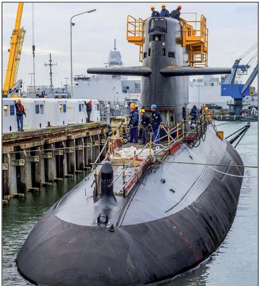
Ostatnie modernizacje jednostek typu Walrus/Zeeleeuw objęły m.in. systemy łączności satelitarnej ultrawysokiej częstotliwości (SATCOM), komunikacji wewnętrznej, czy też montaż masztu elektrooptycznego, który nie wsuwa się już do kadłuba ciśnieniowego.
