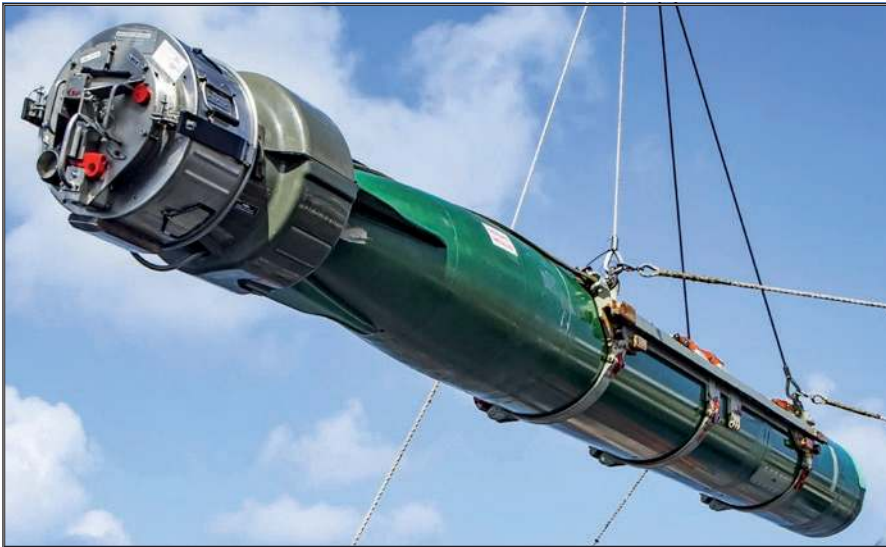
Główny oręż okrętów podwodnych typu Walrus/Zeeleeuw stanowią obecnie amerykańskie torpedy ciężkie Mk 48 Mod. 7 ADCAP/CBASS.
