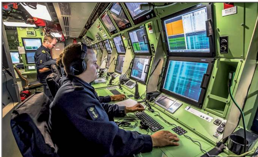
Zmodernizowane CIC w centrali okrętu podwodnego typu Walrus/Zeeleeuw.
