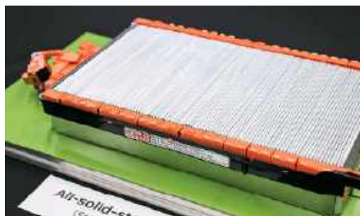
2. Zademonstrowany przez Toyotę układ ogniów półprzewodnikowych o stałym elektrolicie © Toyota
