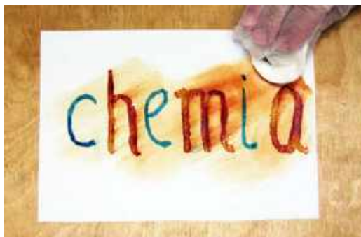
5. Tekst sporządzony roztworami żelazocyjanku i rodniku potasu po wywołaniu roztworem chlorku żelaza(III) ujawnia się w postaci dwubarwnego napisu
