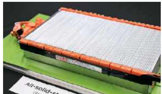
2. Zademonstrowany przez Toyotę układ ogniwa półprzewodnikowych o stałym elektrolicie © Toyota
