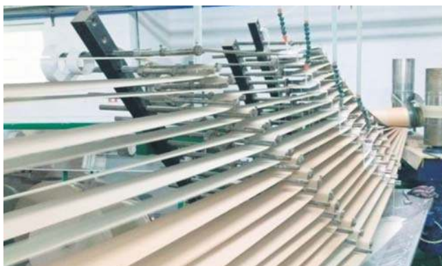
Tuleje tekturowe konstrukcyjne i nawojowe zwijane są spiralnie lub równoległe.
