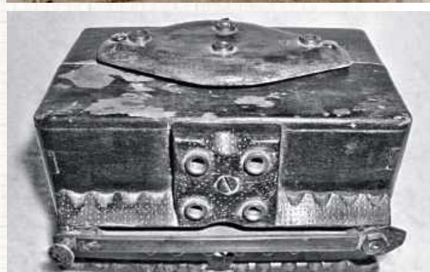
Radio kryształkowe: Strojenie do stacji odbywało się suwakiem widocznym u dołu zdjęcia. Nad suwakiem dwa podwójne gniazdzka na słuchawki. U góry – pośrodku miejsce na detektor kryształkowy, a dwa skrajne gniazdzka służyły do podłączenia anteny i uziemienia
