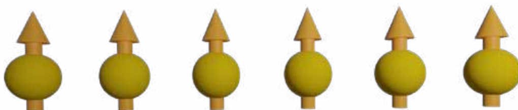
Rys. 1. Schematyczne i uproszczone przedstawienie ferromagnetyki . Atomy (symbolizowane przez kule) wykazują moment magnetyczny (symbolizowany przez strzałki). Ich kierunek i zwrot są uporządkowane w wybranym kierunku (tutaj – w górę) bez zewnętrznego pola.
