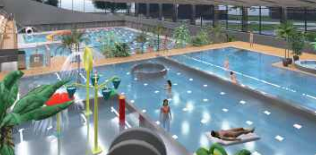
Modernizacja obiektu przy Al. Partyzantów zakłada powiększenie hali basenowej o 4,5 przęsła kosztem istniejącej hali sportowej oraz rozbudowę zespołu zjeżdżalni od południowej części hali
