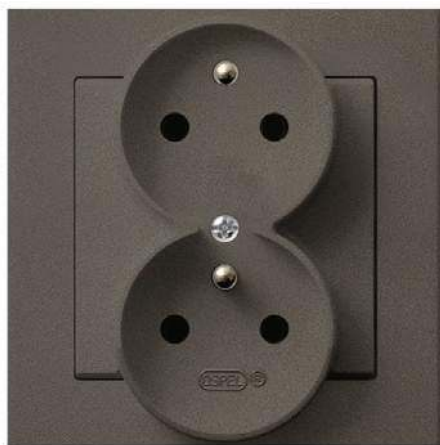
Przy takim układzie styków ochronnych, użycie dwóch wtyczek kątowych będzie bardzo trudne. OSPEL
