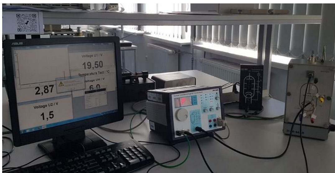
Ryc. 2. (a) Stała Plancka h podana jest na tablicy przy wejściu do Instytutu Fizyki UMK. Przez ostatnie 50 lat kilkakrotnie poprawiano tę stałą. Od 2014 roku, tj. od przyjęcia nowego standardu stałych fizycznych, to liczba \pi pozostaje niedokładna, a stała h już się nie zmienia. (b) Zestaw firmy Phywe do doświadczenia Francka-Hertza. Z prawej strony ampulka z rtęcią, zamknięta w metalowej obudowie z regulowaną temperaturą, w środku zasilacz z trzema regulowanymi napięciami – żarzenia katody, napięcia przyspieszającego elektrony i napięcia selektywnie hamującego elektrony, które straciły energię w zderzeniach z atomami. Po lewej stronie – ekran komputera sterującego doświadczeniem. W głębi – czarna obudowa ampulki z neonem. Foto BJ.
