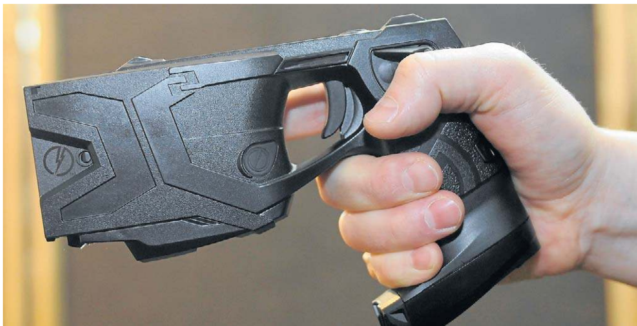
Taser pozwala na rażenie osoby z odległości kilku metrów. Działa na zasadzie ładunku gazowego, który wyrzuca elektrody, przenoszące wysokie napięcie prądu elektrycznego (nawet do 150 tys. V), ale o niskim natężeniu
