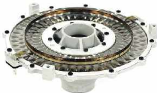
Pierścieniowa membrana średnio-wysokotonowego ma dużą powierzchnię, pofalowaną dla rozproszenia rezonansów, a cewka drgająca ma średnicę aż 12,5 cm
