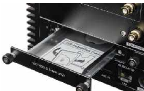
Dwuipółcalowe dyski twarde umieszczamy w dwóch kieszeniach.
