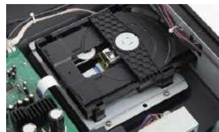
W większości odtwarzaczy Rotel w specjalny sposób montuje napęd, obniżając w tym miejscu obudowę i stosując dodatkową, dolną platformę.
