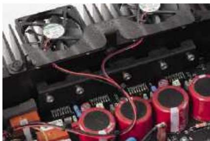
Końcówki mocy w klasie AB bazują na układach scalonych.
