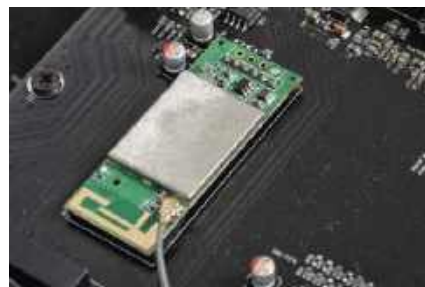
Na oddzielnej płycie umieszczono elektronikę strumieniową.
