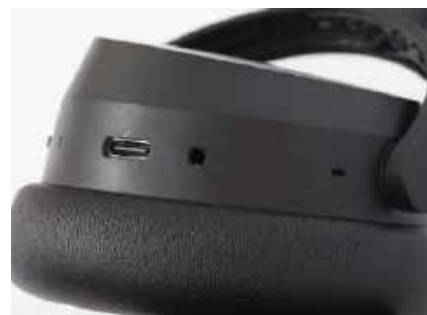
Na dolnej krawędzi znajduje się złącze USB (do ładowania), 3,5-mm analogowe wejście oraz włącznik zasilania.
