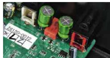
Idąc śladami wersji specjalnej "Tribute", w torze analogowym założono wysokiej jakości elementy pasywne.
