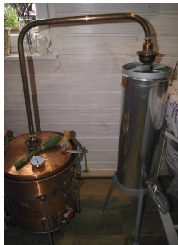
Urządzenie do destylacji olejków z lawendy
