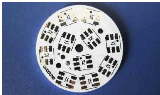
Fotografia 5. Laminat na podłożu aluminiowym [5]
