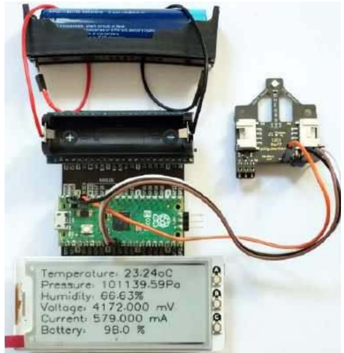
Fotografia 2. Płytkę Pico-UPS-A dołączona do ekspandera Pico
