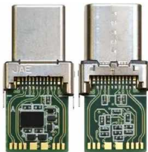
Fotografia 15. Widok obu stron płytki drukowanej z wtykiem USB-C i układem E-Mark ( https://t.ly/ThOnt )
