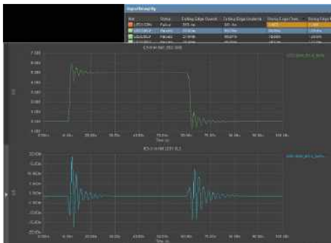
Rysunek 8. Wyniki przykładowej symulacji integralności sygnałów wykonanej w środowisku Altium Designer ( https://t.ly/Sgh2e )
