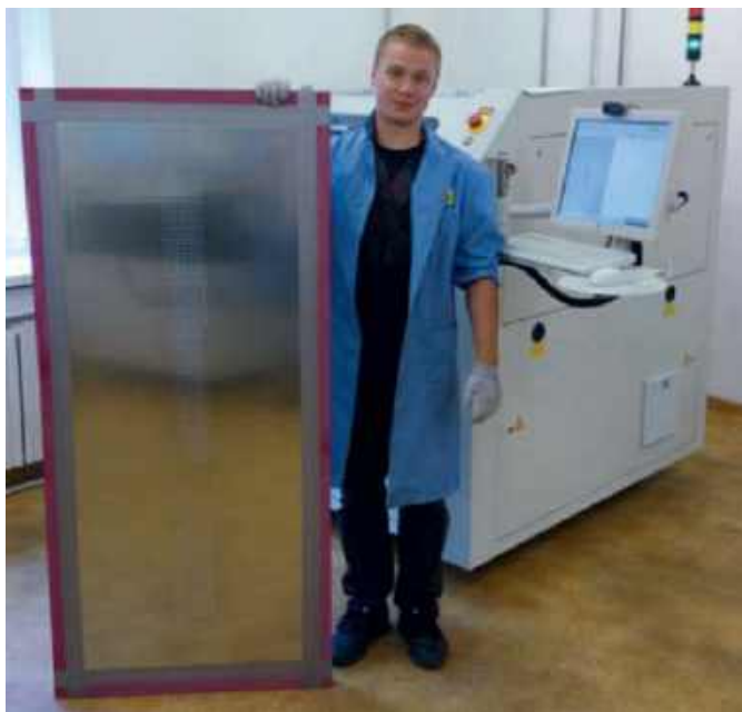
Fotografia 4. Długi szablon w ramie aluminiowej do produktów LED (Semicon sp. z o. o.)
