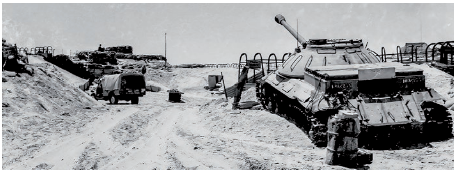
▲ Czołg IS-3 UKN ustawiony jako punkt ogniowy na izraelskiej pozycji „Budapest” w rejonie Port-Saidu, początek lat 70. XX wieku. Widoczne są zmiany w tylnej części kadłuba. M.in. widać pokrywę w tylnej płycie kadłuba.
