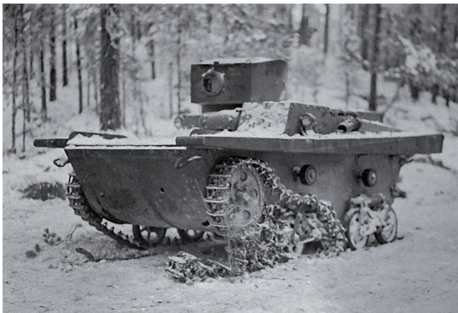
▲ Czołgi lekkie T-37A (na zdjęciu) i T-38 okazały się całkowicie nieprzydatne do wykonywania zadań rozpoznawczych. Ich opancerzenie (przednie i boczne – 9 mm, tylne – 6 mm i górne – 4 mm, wieży – 6 mm) okazało się niewystarczające (bez problemu przebiły je pociski z cekaemów). Na zdjęciu doskonale widoczne są przebicia przedniej płyty kadłuba.
