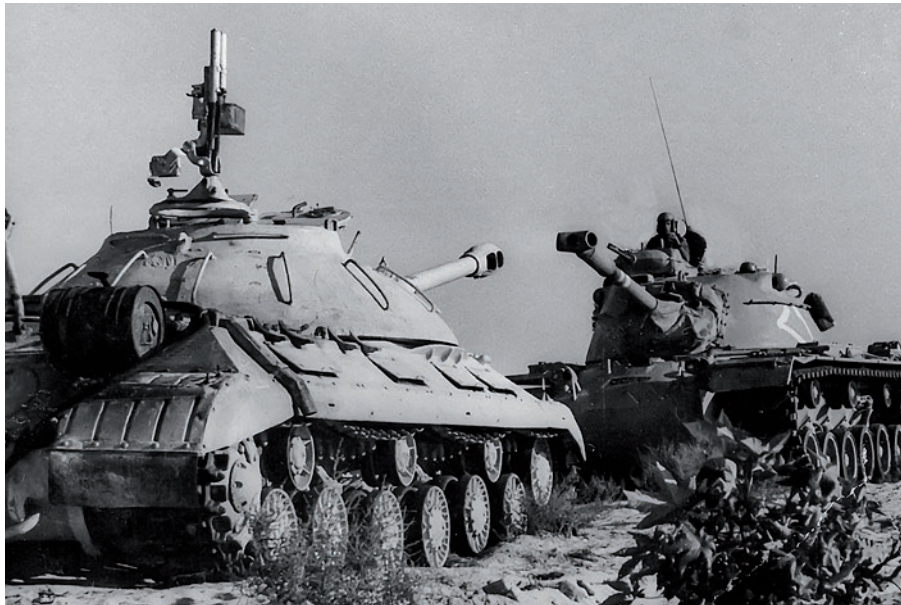
▲ Propagandowe izraelskie zdjęcie wykonane w czasie „wojny sześciodniowej” w 1967 r. pokazujące „spotkanie” IS-3 UKN z czołgiem M48A2C Patton ( Magach 2 ). Na tylnej części kadłuba Stalina widoczne są modyfikacje układu wydechowego wprowadzone przez Egipcjan.
