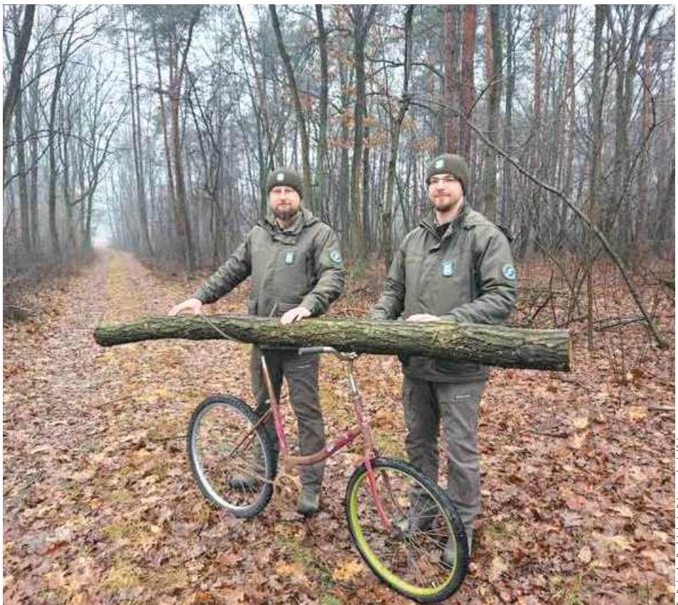
Niedaleko miejsca, gdzie wycięto drzewa, strażnicy znaleźli ten oto rower przygotowany do przewożenia kłoci. Jednośląd został pozbawiony pedałów i łańcucha, czyli elementów, w które coś mogłoby się zaplątać, a zamiast siodła ma przyspawany uchwyt w kształcie litery U. Strażnicy na zdjęciu prezentują, w jaki sposób sprawca kradzieży wywoził drewno z lasu, nie pozostawiając śladu
