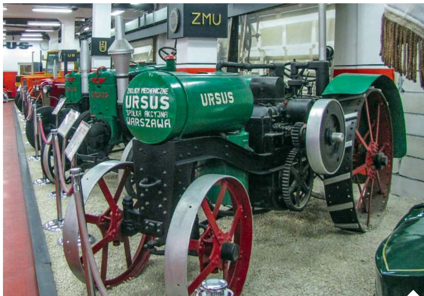
Ursus, model 1921/1922, tzw. ciągówka, pierwszy polski ciągnik rolniczy. W latach 1922–1927 wyprodukowano ich 100 sztuk | fot. ZMU/d
