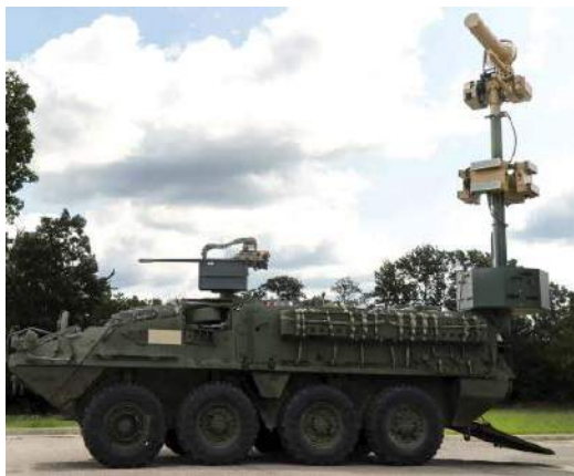
4. Element systemu AUDS zamontowany na wozie bojowym
