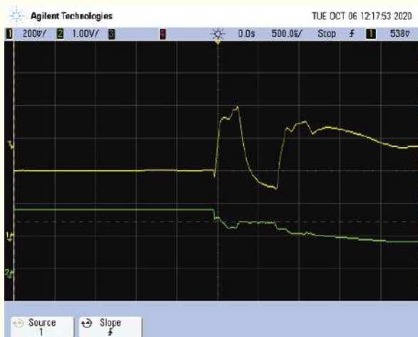
Oscylogram 1. Reakcja na wzrost obciążenia, który wyzwala ograniczenie prądu. Żółty przebieg to napięcie na rezystorze pomiarowym, więc jest proporcjonalne do prądu, podczas gdy zielony przebieg jest proporcjonalny do napięcia wyjściowego. Występuje pewne przekroczenie prądu, głównie z powodu pojemności na wyjściu, po czym włącza się ograniczenie prądu, zmniejszając napięcie wyjściowe, aby osiągnąć stan ustalony w ciągu 1 ms
