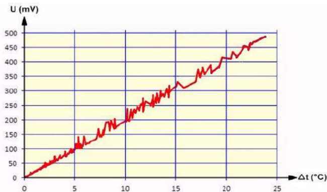
Zależność między napięciem na elemencie Peltiera a różnicą temperatur po obu stronach ogniwa (© www.ydom.ru, edytuj Jos Verstraten)
