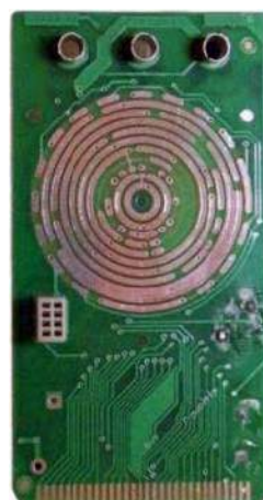
Konstrukcja przełącznika (© 2023 Jos Verstraten)
