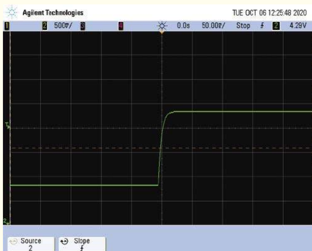
Oscylogram 3. Skokowy wzrost ustawionego napięcia (tym razem z 3,3 V do 5 V przy obciążeniu 12 \Omega ) jest znacznie szybszy ze względu na niższą impedancję tranzystora wyjściowego, trwając zaledwie kilka milisekund
