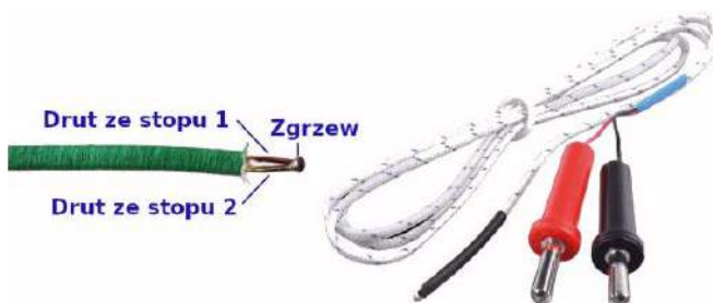
Typowy przykład termopary dostarczanej z multimetrem (© 2023 Jos Verstraten)
