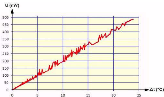
Zależność między napięciem na elemencie Peltiera a różnicą temperatur po obu stronach ogniwa (© www.ydom.ru, edytuj Jos Verstraten)
