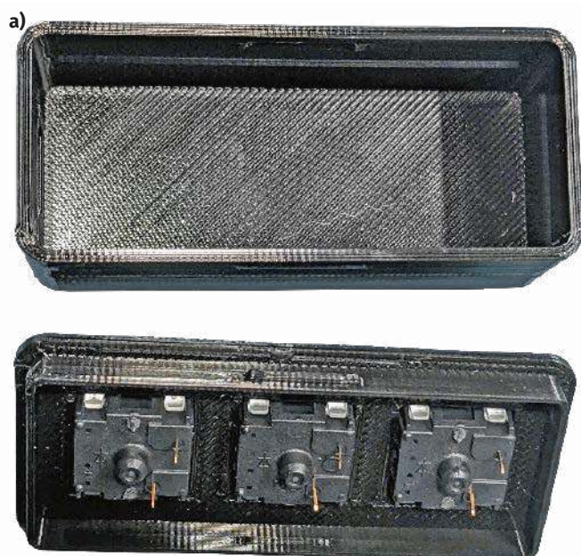
Fotografia 1. a) Przyciski zamontowane w obudowie; b) przyciski zabezpieczone klejem na ciepło
