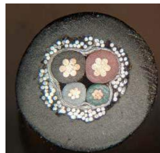
Fotografia 9. Przekrój typowego kabla USB 2.0 ( https://t.ly/YBJJ )
