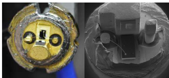
Fotografia 2. Zdjęcie mikroskopowe diody laserowej małej mocy
