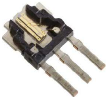
Fotografia 3. Dioda laserowa typu LNCT28PF01WW Panasonic zawiera w jednej strukturze laser czerwony i podczerwony (IR) o długościach fali 665 nm i 791 nm
