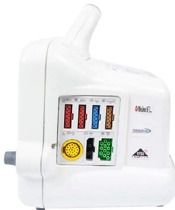
Fotografia 1. Panel gniazd sygnałowych w kardiomonitorze GE Dash 3000. Uwagę zwraca zróżnicowanie kształtów, kolorów korpusów izolacyjnych oraz ułożenia kluczy kodujących orientację złączy ( https://t.ly/DvPo )
