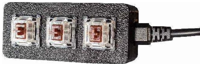
Fotografia 5. Moduł Arduino wraz z przewodem USB w wydrukowanej obudowie – gotowa miniklawiatura
