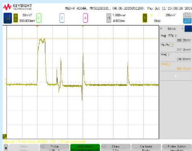
Rysunek 11. Pomiar dynamiczny z napięciową sondą różnicową
