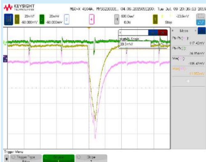
Rysunek 10. Impuls prądowy aktywności debugowej
