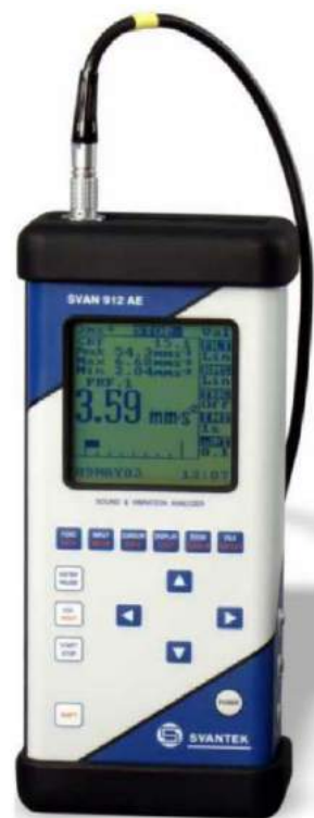
Fotografia 8. Analizator dźwięku i drgań SVAN 912AE
