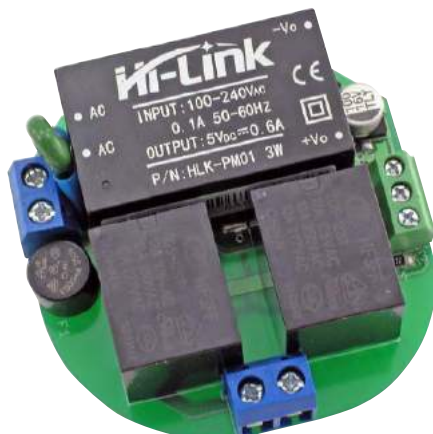
Fotografia 4. Zmontowany sterownik, widok od strony TOP
