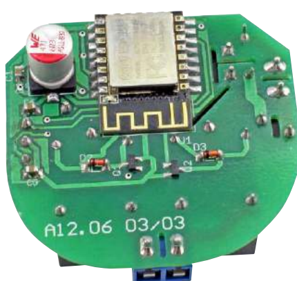
Fotografia 5. Zmontowany sterownik, widok od strony BOTTOM
