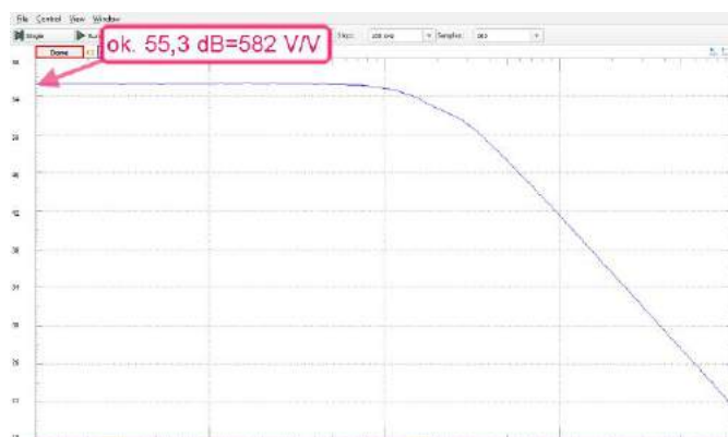
Rysunek 25. Wstępny pomiar charakterystyki częstotliwościowej narzędziem Network Analog Discovery 2
