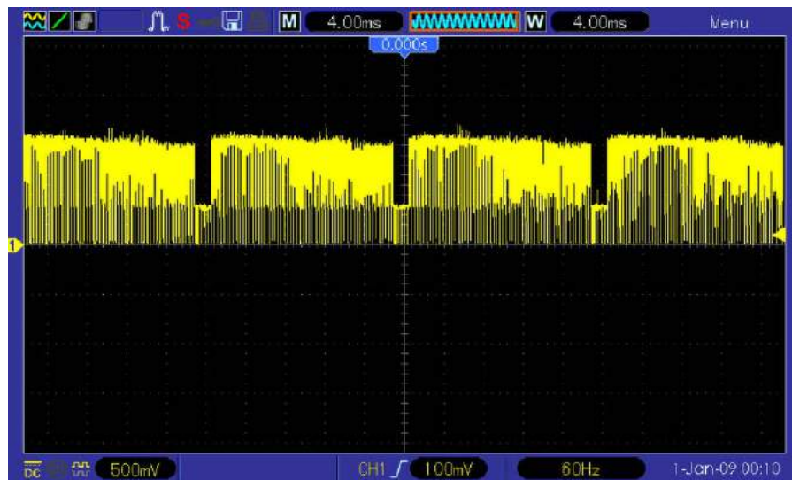
Rysunek 3. Okresowe szczeliny w przebiegu czasowym zespolonego sygnału wideo
