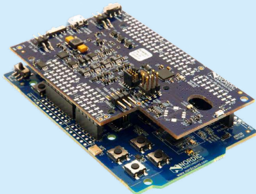
Fotografia 6. Zestaw uruchomieniowy nRF52840 DK z dołączoną płytką zestawu Power Profiler Kit [7]
