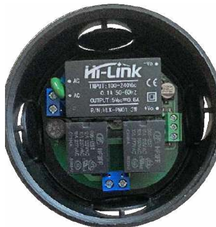
Fotografia 6. Zmontowany sterownik umieszczony w puszcze instalacyjnej
