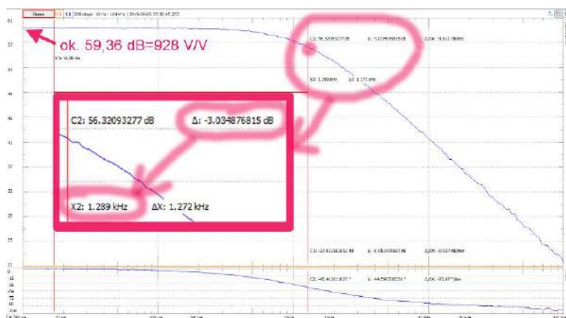
Rysunek 27. Charakterystyka wzmacniacza zmierzona narzędziem Network z zastosowaniem symulatora tensometrów
