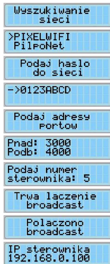
Rysunek 11. Etapy konfiguracji sterownika WRC-10
