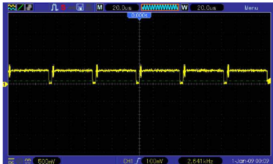
Rysunek 1. Przebieg czasowy zespolonego sygnału wideo przy zaczernionym obrazie
