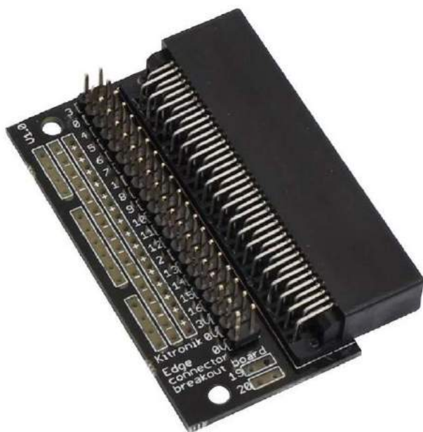
Fotografia 2. Gniazdo dla złącza krawędziowego
