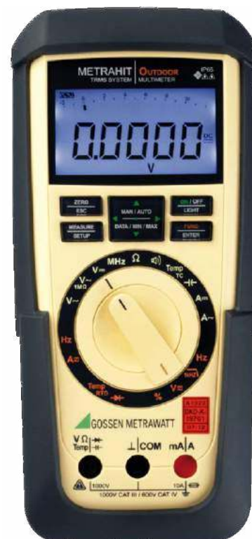
Fotografia 11. Multimetr METRAHIT OUTDOOR spełniający wymagania IP65, CAT III 1000 V, CAT IV 600 V
