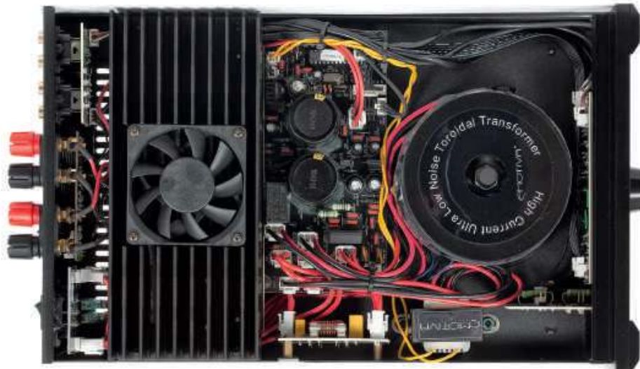
W wąskiej obudowie nie było dużo miejsca, ale zmieściły się zarówno solidny zasilacz, jak i końcówka mocy ze sporym radiatorem.
