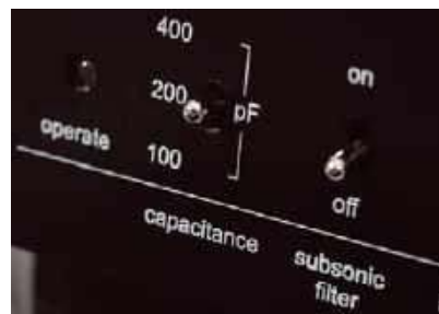
Hebelkami regulujemy pojemności wejścia i włączamy filtr subsoniczny.
