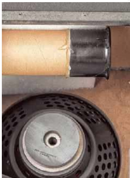
Otwór bas-refleks ułożono blisko jednej z tylnych nóg.
