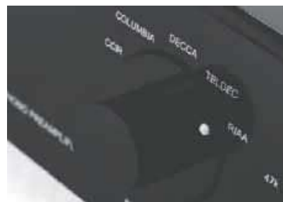
Jedną z ciekawostek funkcjonalnych przedwzmacniacza jest możliwość wyboru jednej z pięciu krzywych korekcyjnych.
