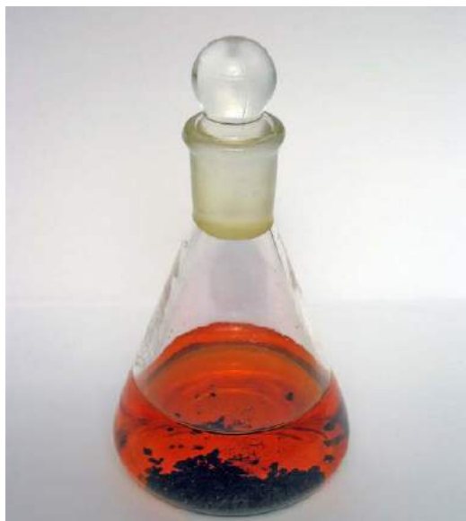
3. Woda jodowa w kolbie (na dnie widoczne kryształy jodu).
