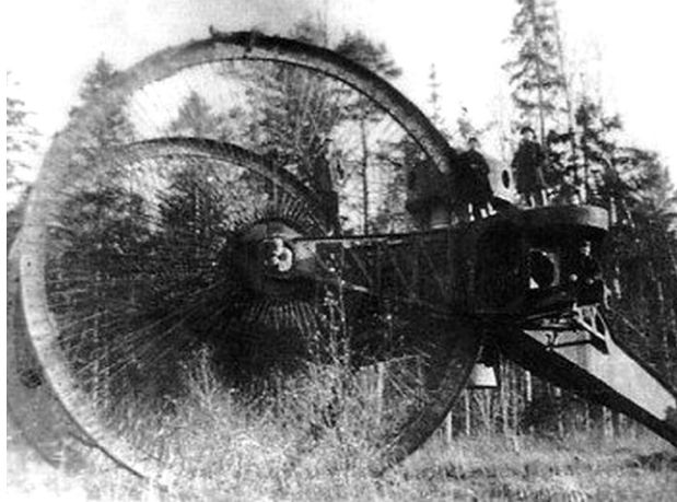
2. Car-czołg, zbudowany w pojedynczym egzemplarzu prototypowym wedle projektu Nikołaja Lebiedienko, nie był w stanie dźwignąć samego siebie i stał się wyjątkowo łatwym celem dla artylerii przeciwnika – to wszystko było nader widoczne dla każdego inżyniera owych czasów już po pierwszym spojrzeniu na projekt szkicowy. Mimo to polecenie cara Mikołaja II spowodowało zbudowanie egzemplarza prototypowego, który udowodnił ponad wszelką wątpliwość to, co było oczywiste od samego początku (fot. nieznanego autora z lat 20. XX stulecia; źródło: pl.wikipedia.org).
