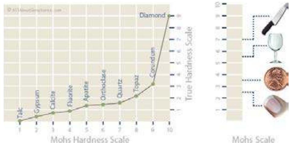
Rys. 3. Bardzo użyteczna, względna skala twardości Mohsa: materiał twardszy zostawia rysę na materiale miększym: twarda stal rysuje szkło a piasek (kwarc) rysuje stal. Paznokieć ma twardość ok. 2,5, czyli można nim zarysować gipsową ścianę, miedź ma 3,5, szkło 5,5, pilnik do paznokci ok. 6,5. (AllAboutGemstones.com, dostęp 2012)
