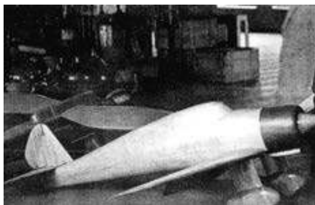
Rys. 9. Model tunelowy samolotu myśliwskiego PZL-45 Sokół. Z tyłu model LWS-7 Mewa II.
