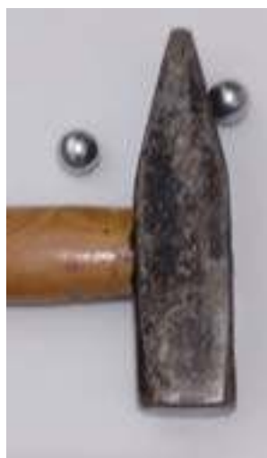
Fot. 2. Wykorzystanie obucha młotka, jako płyty trójkątnej do badania zderzeń.
