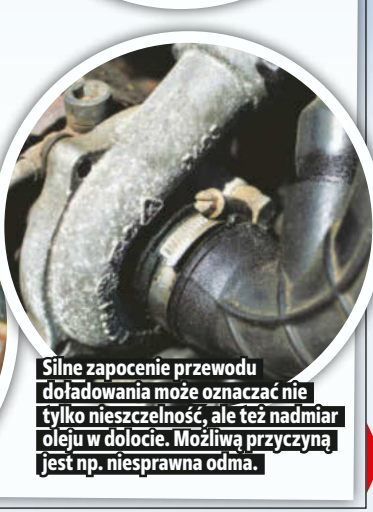
Użytkownicy, ale i mechanicy często ignorują odmę. Tymczasem to wyjątkowo ważny układ dla silnika.
