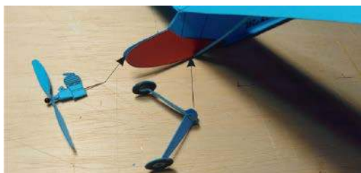
Silnik wklejamy pomiędzy okładziny kadłuba, podwozie od spodu kadłuba
