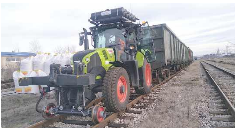
Po przeróbce ciągniki szynowo-drogowe mogą ciągnąć po szynach nawet skład ważyący do 800 ton
