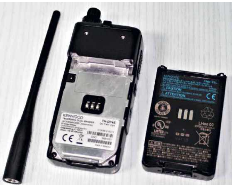
Rys. 2. TH-D74E, widok od tyłu oraz bateria KNB-75L (1800 mAh) i oryginalna antena. Egzemplarz na zdjęciu został poddany wnikliwym testom opisanym w artykule
