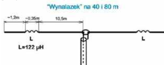
Rys. 4. Szkic konstrukcji anteny dwupasmowej 40/80 m wg SP8BWR
