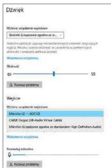
Rys. 4. Po zainstalowaniu programu Kenwood ARFC-D74 i podłączeniu TH-D74E przewodem USB do komputera, radiostacja jest widoczna jako Mikrofon (1-ADC1.0), a dźwięk przesyłany jest przewodem USB
