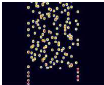
Rys. 1. Olivia 32-1000 na wskaźniku wodospadowym. W zależności od rozdzielczości ekranu i programu terminalowego punkty mogą być w mniejszym lub większym stopniu rozciągnięte w kierunku poziomym
