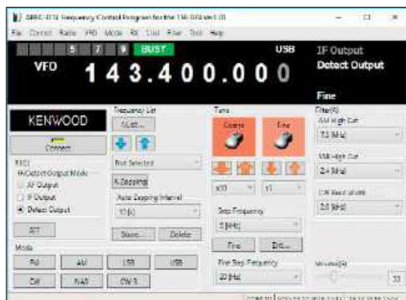
Rys. 11. Program ARFC-D74 firmy Kenwood pozwala m.in. na zdalne sterowanie radiostacją, np. ustawienie częstotliwości, rodzaju modulacji, filtrów etc.
