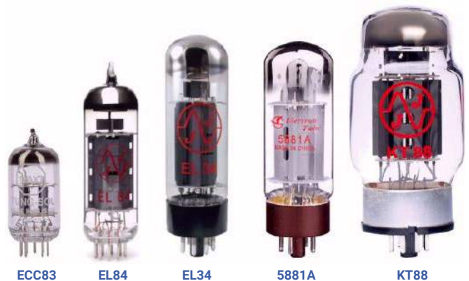
Wygląd lamp nadal powszechnie stosowanych we wzmacniaczach audio (© 2021 Jos Verstraten)
