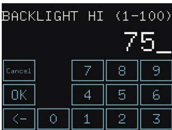
Ekran 6. Prostsza klawiatura numeryczna służy do wprowadzania procentowych wartości jasności podświetlenia. Dostępne jest jedno ustawienie dla aktywnego korzystania z ekranu dotykowego i drugie ustawienie przyciemnienia po upływie limitu czasu. Aby uzyskać najlepszą wydajność dźwięku, sugerujemy użycie 0% (podświetlenie wyłączone) jako wartości limitu czasu
