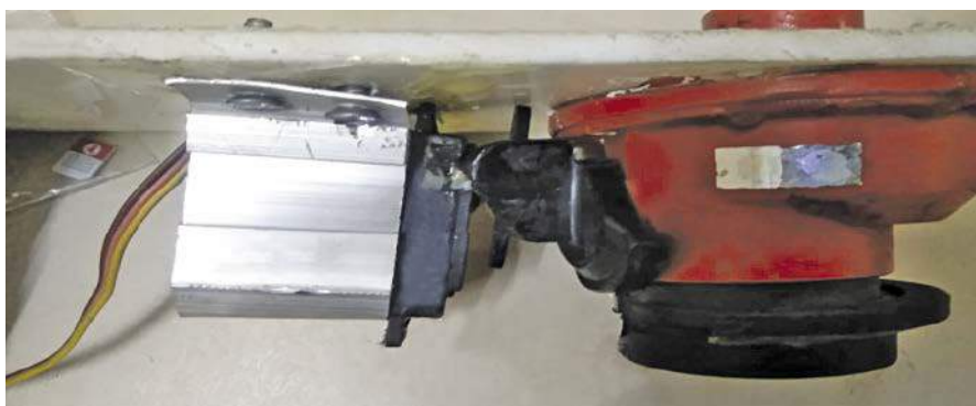
Rysunek 6. Połączenie serwa z zaworem głównym
