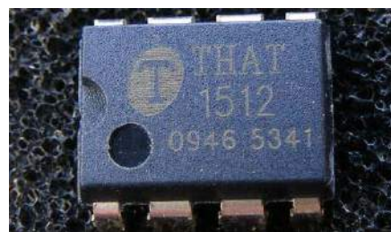
Rysunek 13. Zintegrowane rozwiązanie CFIA, That 1512 firmy Profusion. Opracuję dla niego obwód, mam nadzieję, że bez dużego kondensatora elektrolitycznego w obwodzie potencjometru regulacji wzmacnienia
