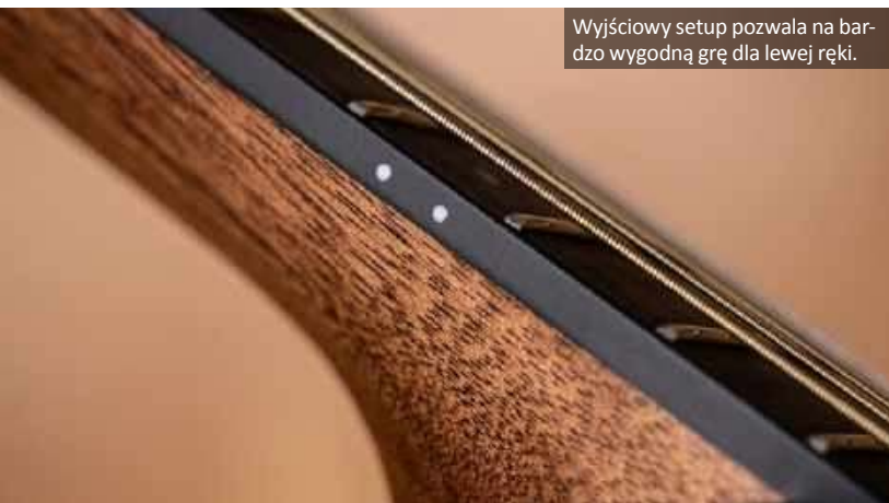
Na palisandrowej podstrunnicy nabitą i starannie oszlifowaną 20 średnich progów.
