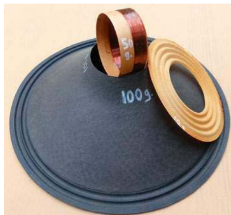
Masa cewki dużej mocy produkcji PMP stanowi połowę masy firmowej membrany z zawieszonymi.
