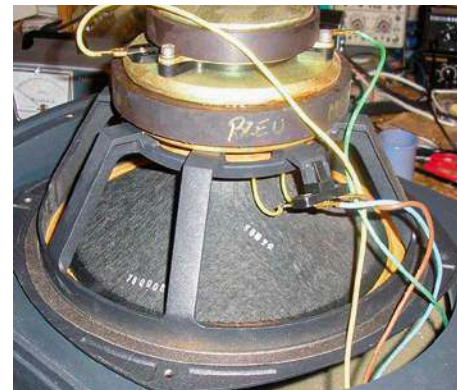
Koaksjalne głośniki monitorowe Tannoy, produkowane w ubiegłym wieku, wyposażone były w klasyczne magnesy ferrytowe, które nie są wrażliwe na wysokie temperatury.
