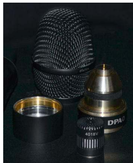
„Główkę” mikrofonu w wersji dla nadajnika handheld tworzą trzy części – adapter, kapsuła i siatka ochronna (grid). Między korpusem nadajnika a „główką” jest jeszcze pierścień o dwóch różnych gwintach, za pomocą którego przetwornik montuje się do nadajnika.
