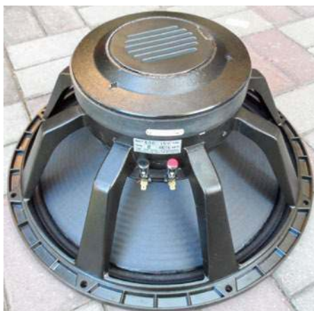
Klasyczny obwód głośnikowy, wykorzystujący magnes ferrytowy.
