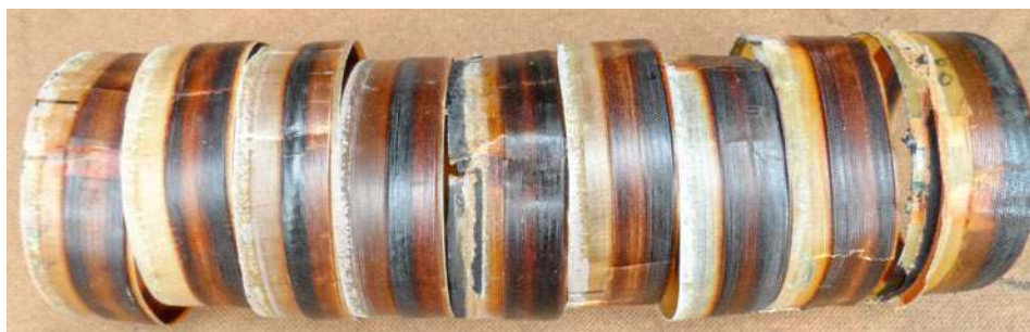
Cienki nabiegunknik i cewka o wysokim uzwojeniu to połączenie, które często prowadzi do uszkodzeń głośników.
