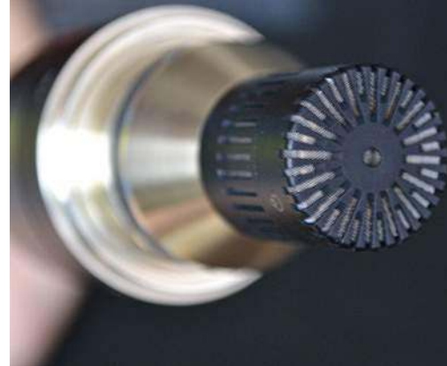
Kapsuła mikrofonu d:facto bazuje na konstrukcji kardoidalnego mikrofonu pojemnościowego d:dicate 4011.
