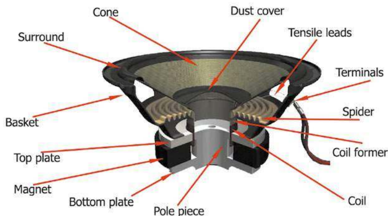
Diagram pokazujący proporcje między wysokością cewki i nabiegunknika.
