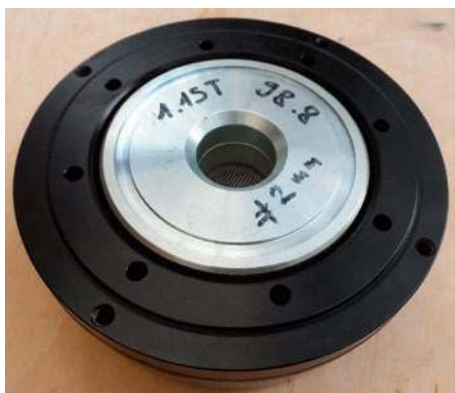
Poziom SPL głośnika w znacznym stopniu zależy od natężenia pola magnetycznego w szczeliny i konstrukcji obwodu magnetycznego.
