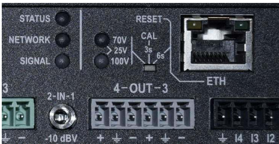
Jedynym elementem regulacyjnym wzmacniacza jest ukryty pod powierzchnią tylnego panelu microswitch, służący do ręcznego wyboru opcji wyjścia, resetowania połączenia sieciowego oraz uruchomienia funkcji autokalibracji.
