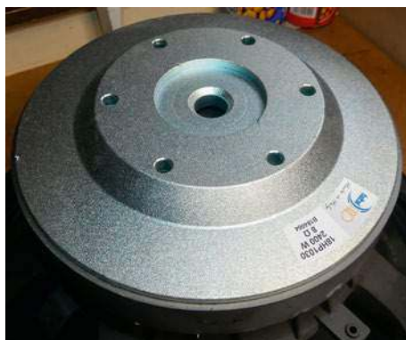
Mechaniczna konstrukcja obwodu magnetycznego ma duży wpływ na wartość natężenia pola magnetycznego w szczelinie.
