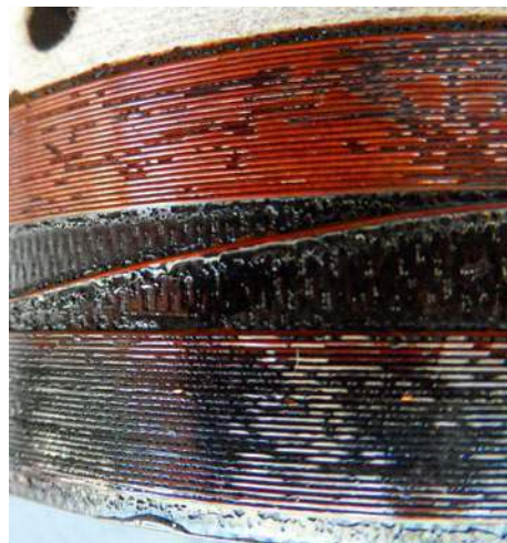
Totalna destrukcja cewek na skutek wysokiej temperatury nie zawsze musi prowadzić do uszkodzenia neodymowego obwodu magnetycznego.
