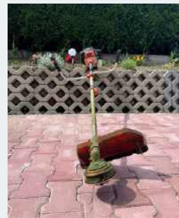
🔴 W kosie spalinowej wykorzystuje się głównie żyłkę, a nie tarczę tnącą.
