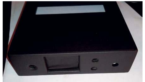
Gotowa obudowa po malowaniu
