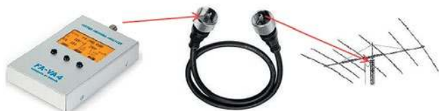
Rys. 3. Pomiar na drugim końcu kabla antenowego. Kabel transformując impedancję wpływa znacząco na wynik
