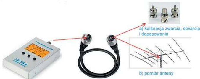
Rys. 4. Eliminacja wpływu kabla antenowego przez kalibrację w stanach zwarcia, rozwarcia i dopasowania na końcu kabla antenowego
