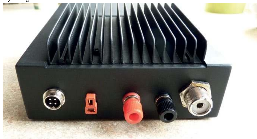
Widok tylnej ścianki obudowy, gniazdo mikrofonowe, gniazdo głośnikowe, dwa zaciski zasilania, gniazdo antenowe
