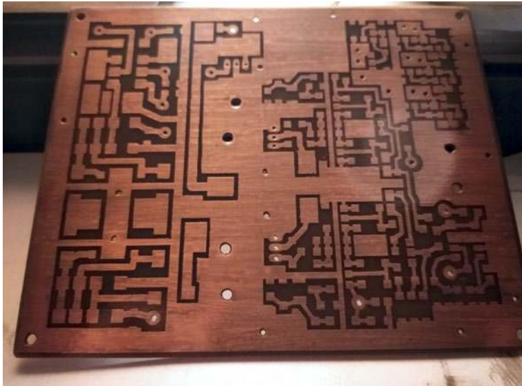
PCB wykonane metodą transferu
