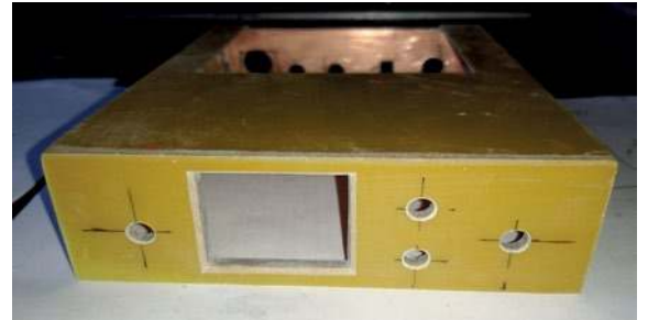
Sposób wykonania obudowy z laminatu
