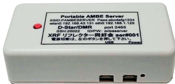
Fot. 3. Portable AMBE Server składa się z Maliny i dodatkowej płytki wokodera
