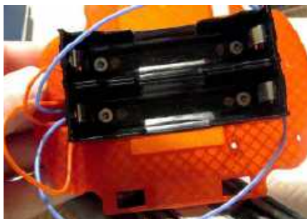
Fotografia 3. Sposób zamontowania koszyków na akumulatorki
