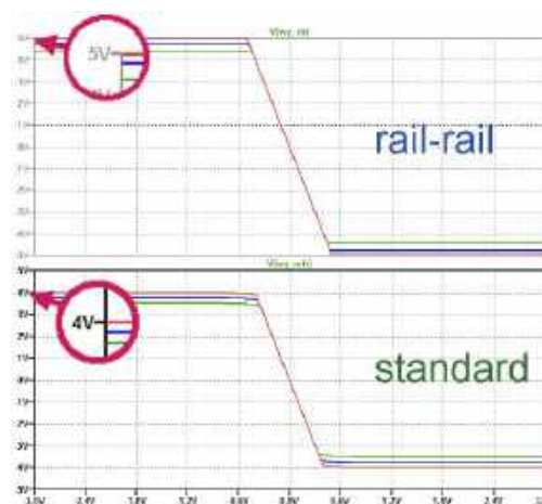
Rysunek 1. Porównanie charakterystyk przejściowych wzmacniacza operacyjnego klasycznego i rail-to-rail
