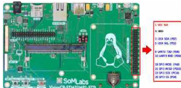
Rysunek 8. Sposób podłączenia modułów peryferyjnych do złącza Raspberry Pi płytki VisionCB-STM32MP1-STD
