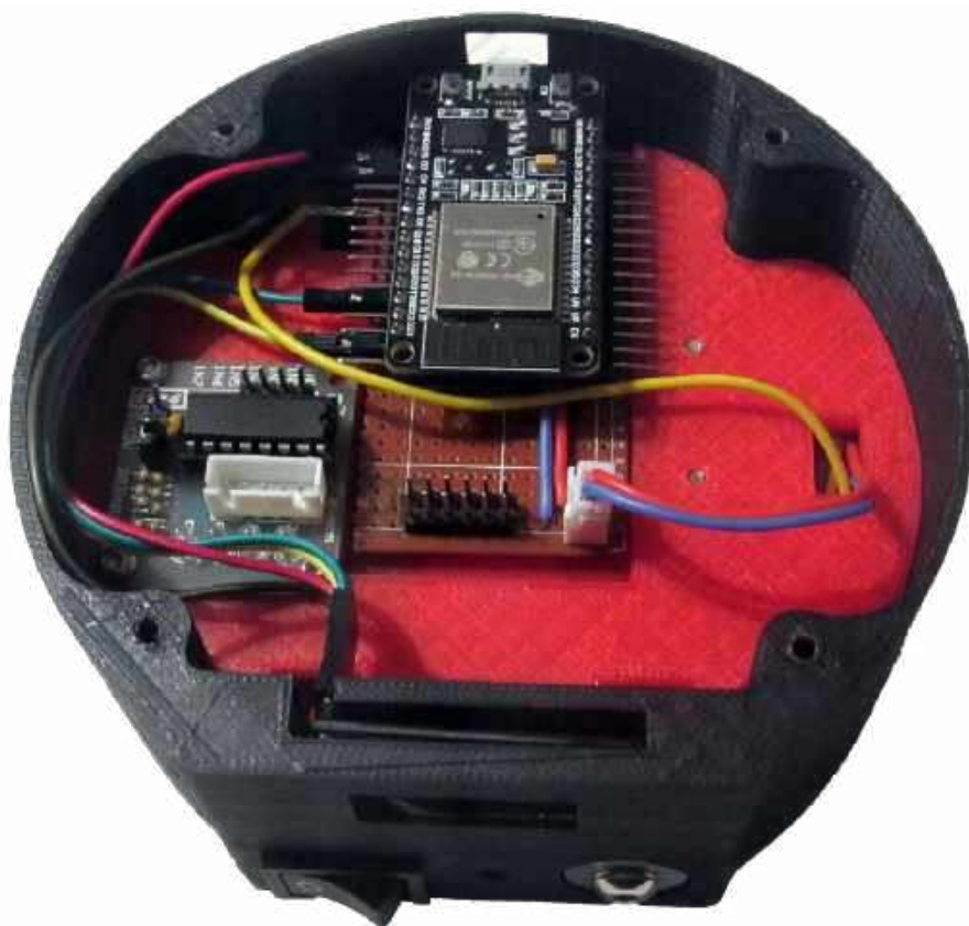
Fotografia 2. Montaż bazy układu wraz z modułami elektronicznymi
