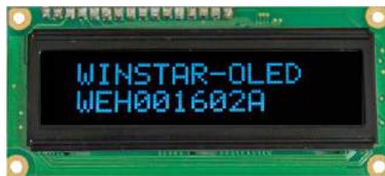
Fotografia 15. Winstar WEH001602ABPP5N0 (z materiałów Unisystem)
