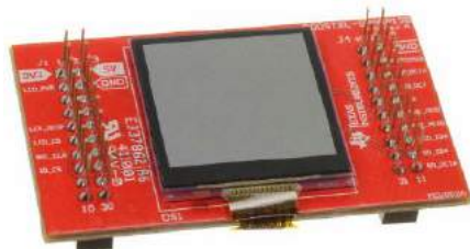
Fotografia 1. Wyświetlacz monochromatyczny MIP LS013B7DH03 w zestawie Booster-pack (z noty TI)
