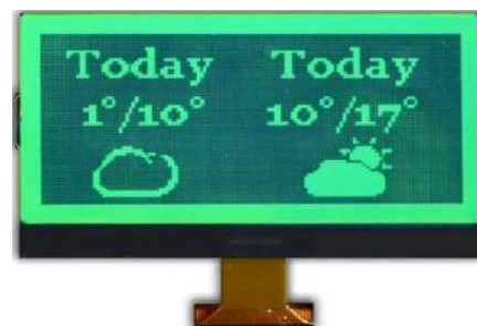
Fotografia 3. ChLCD o niskiej rozdzielczości (za notą Tricomtek)
