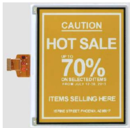
Fotografia 11. Wyświetlacz EA2220-EGA z pigmentem żółtym (za notą Eink)
