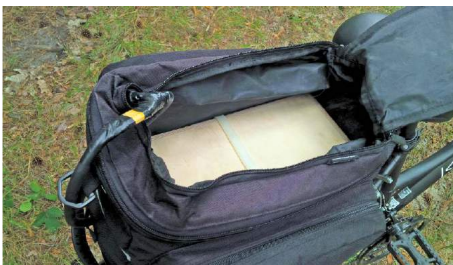
Fotografia 9. Akumulator zamontowany w torbie na bagażniku
