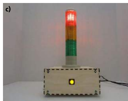
Rysunek 1. Trzy kolory sygnalizatora, dla różnych odsetków udanych ping ów stron w Internecie: a) >50%, zielony, b) 1...50%, żółty, c) 0%, czerwony
