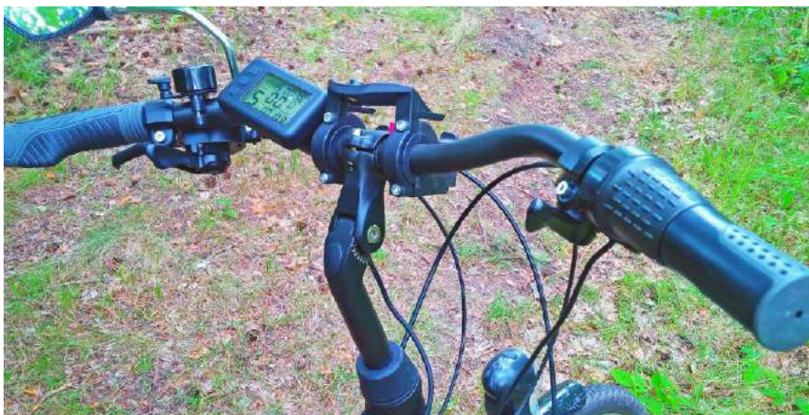
Fotografia 1. Kierownica roweru po konwersji, z zamontowaną manetką i komputerkiem pokładowym
