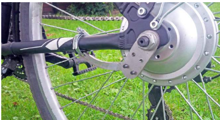
Fotografia 3. Zamontowana blokada obrotu osi silnika
