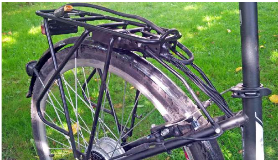
Fotografia 8. Sterownik zamontowany pod bagażnikiem
