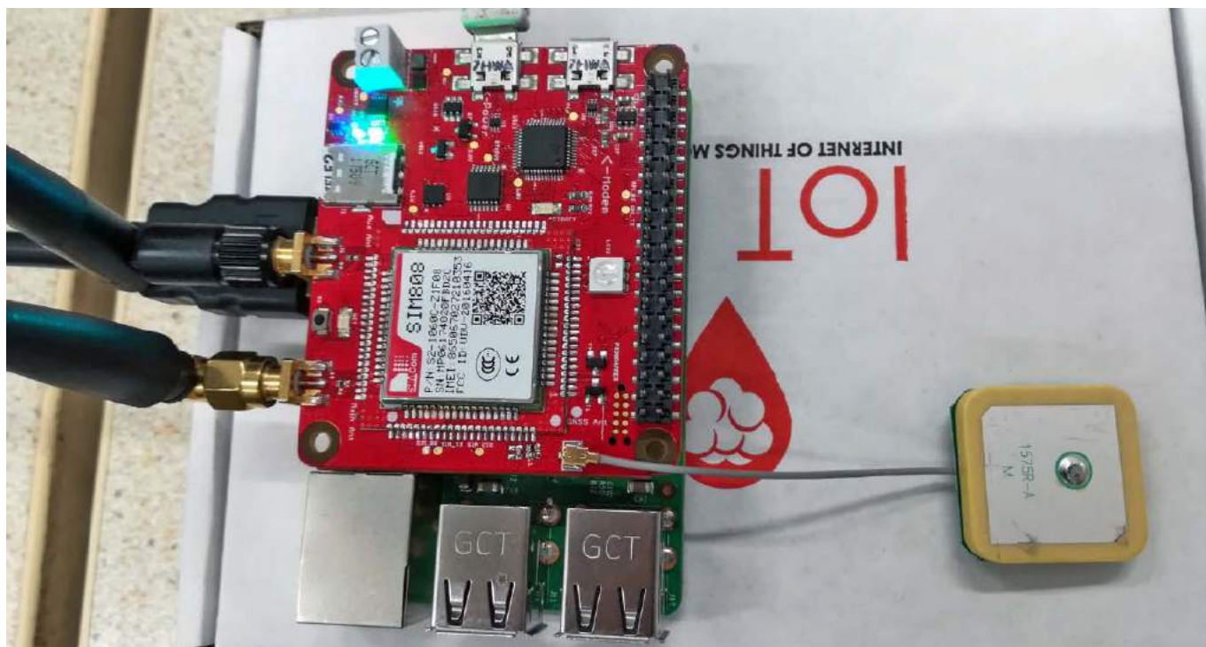
Fotografia 1. Moduł typu HAT z modemem GSM oraz odbiornikiem GPS (czerwone PCB) na Raspberry Pi (zielone PCB).
