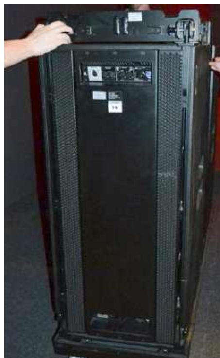
Drugi moduł to nisko-średniotonowy FV-200, w środku którego pracuje osiem przetworników 8-calowych o dużym skoku membrany.
