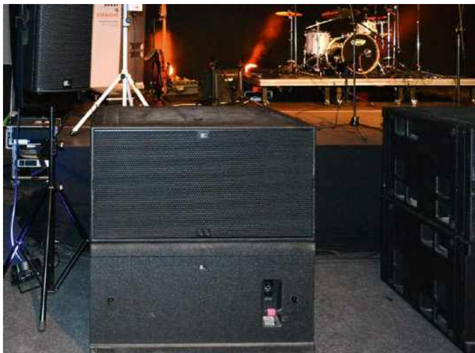
Uzupełnieniem systemu Focus Venue w dole pasma są nowe subwoofery PS-850, zbudowane w oparciu o dwa 18-calowe przetworniki z cewką 4,5”.
