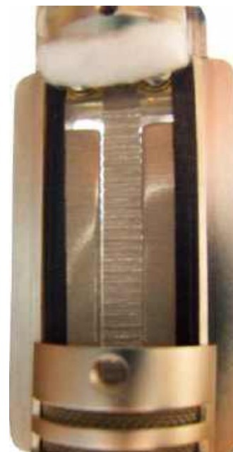
W mikrofonach wstęgowych cienki pasek folii metalowej zwany wstęgą pełni rolę zarówno elementu odbierającego fale akustyczne (membrany), jak i przewodu elektrycznego (cewki).
