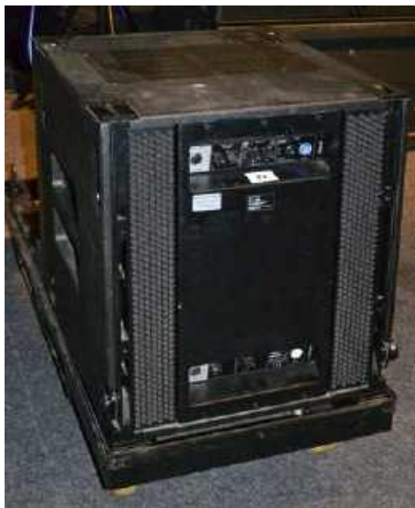
System Focus Venue składa się z dwóch modułów – wysokotonowego FV-100, zbudowanego w oparciu o osiem 1-calowych driverów ciśnieniowych oraz osiem driverów ciśnieniowych o wylocie 1,5”.
