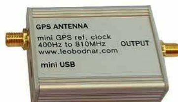
Fot. 6. Generator wzorcowy Mini-GPSDO produkcji firmy Leo Bodnar Electronics jest stabilizowany sygnałami GPS i najpóźniej po upływie minuty od momentu synchronizacji zapewnia stabilność 10-9. Generator jest zasilany przez złącze USB, a jego moc wyjściowa jest ustawiana programowo w zakresie 7,7–13,3 dBm (na 10 MHz)
