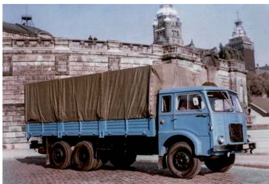
▲ Samochód skrzyniowy Jelcz 316 z kabiną kierowcy typu 407 o ładowności 10 ton.
