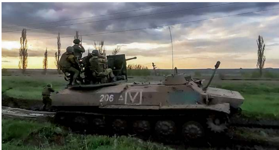
▲ Na rosyjskim podwoziu MT-LB osadzono armatę S-60 (2023 r.). Działą bez dolnej podstawy, z kolei transporter zachował wieżyczkę z karabinem maszynowym.
