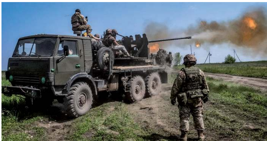
▲ Gun truck z ukraińskiej 28. Samodzielnej Brygady Zmechanizowanej, gdzie dział S-60 posadowiono na podwoziu ciężarówki KamAZ (maj 2023 r.).
