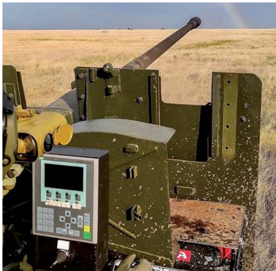
▲ Ukraińskie działko S-60 wyposażone dodatkowo w celownik optoelektroniczny i blok sterowania (lato 2022 r.).
