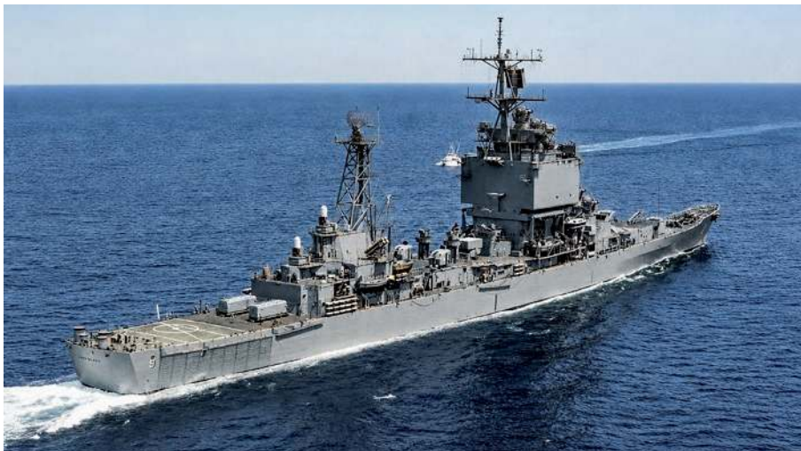
▲ USS Long Beach (CGN-9) – pierwszy na świecie krążownik rakietowy o napędzie atomowym. Połączenie napędu jądrowego i uzbrojenia rakietowego zapowiadało epokę dużych okrętów z praktycznie nieograniczonym zasięgiem operacyjnym.
