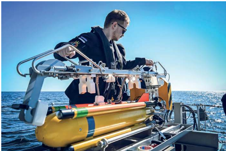
▲ Przygotowanie autonomicznego pojazdu podwodnego (UUV) do realizacji zadania w ramach MCM. Systemy bezzałogowe coraz częściej wspierają działania przeciwmiejskie, rozpoznawcze i związane z ochroną infrastruktury krytycznej na dnie Morza Bałtyckiego.
