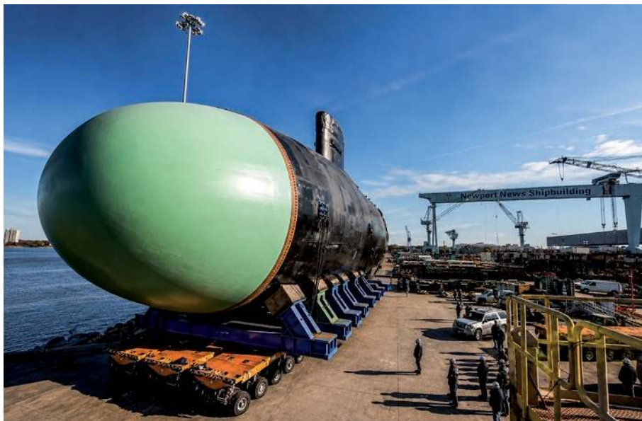
▲ SSBN typu Columbia – nowa generacja strategicznych okrętów podwodnych US Navy. Reaktor PWR trzeciej generacji zaprojektowano tak, aby pracował przez cały, wieloletni cykl życia jednostki bez przeładowania rdzenia.
