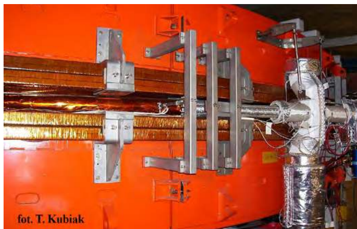
Fot. 5. Jeden z ogromnych magnesów dipolowych zakrzywiających tor wiązki w pierścieniu ESR.
